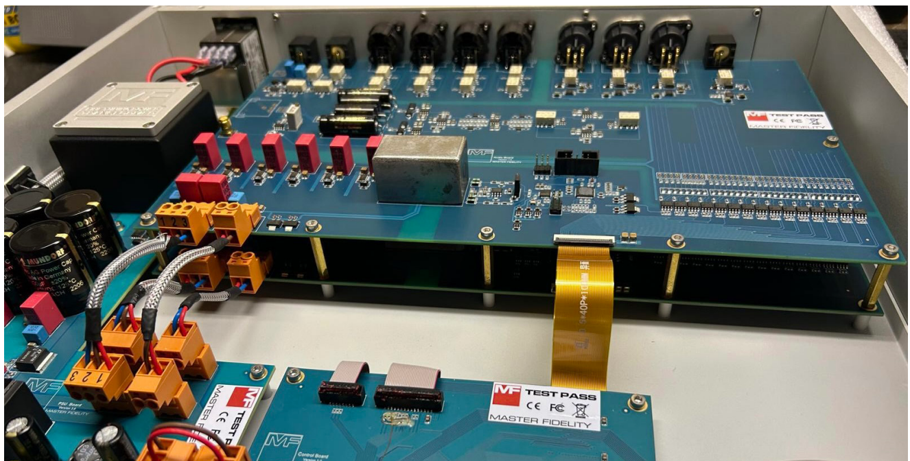
Klare Verhältnisse: Steuerung, Stromversorgung und analoge Signalverarbeitung sind im NADAC L konsequent voneinander getrennt.
