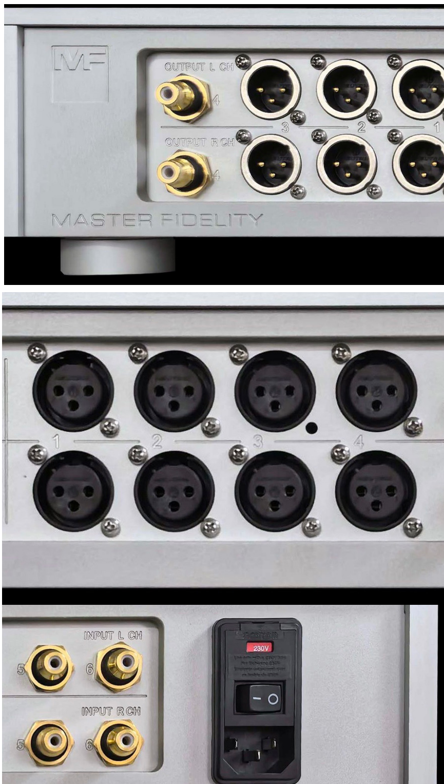
Alles an seinem Platz: sechs Hochpegel-Eingänge, vier Ausgangspaare und die Netz-Sektion.
