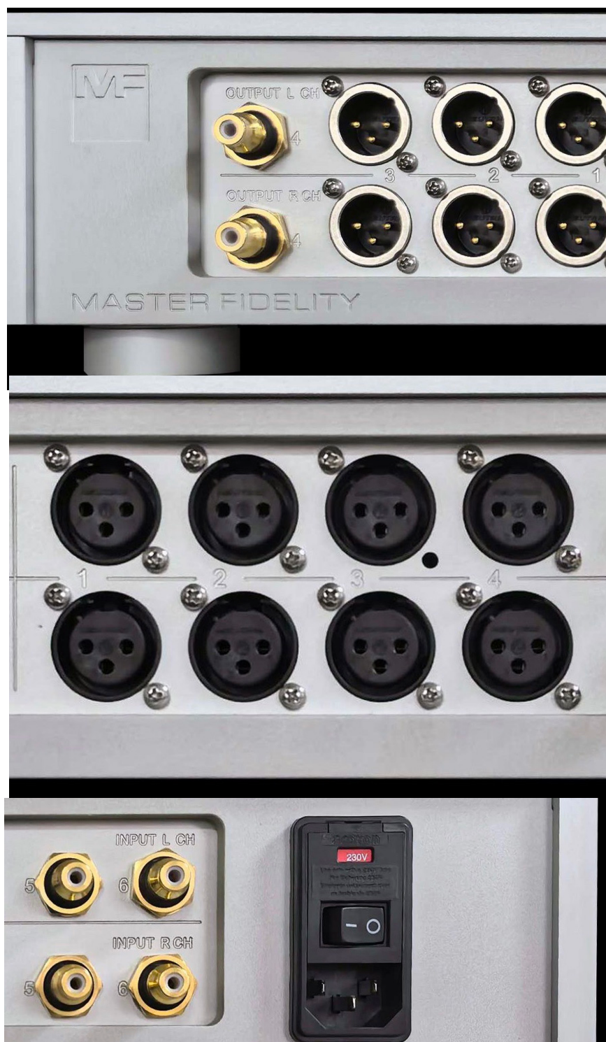
Alles op zijn plaats: zes lijningangen, vier paar uitgangen en de netvoedingssectie.
